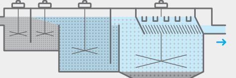
L'eau brute est mélangée avec des réactifs de manière à agglomérer les particules en suspension et former des «flocs».
