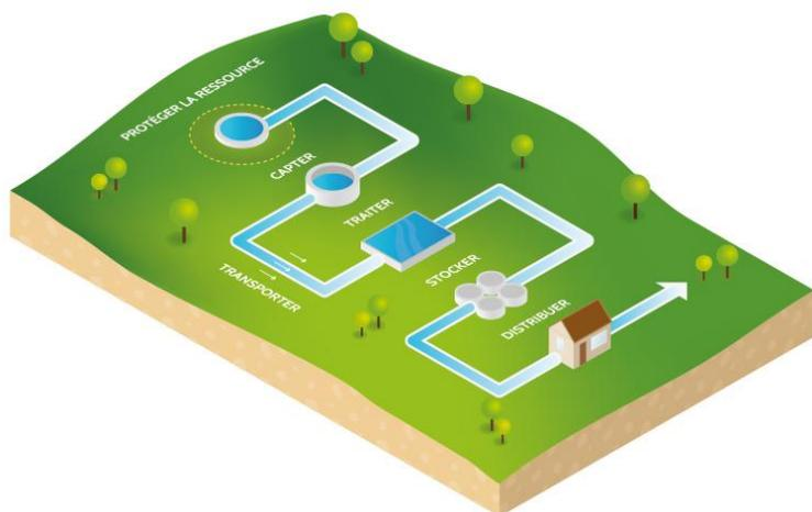
Par ailleurs, il agit dans le cadre du « petit cycle de l'eau » qui correspond au circuit domestique de l'eau. Ce circuit peut être schématisé de la manière suivante :
