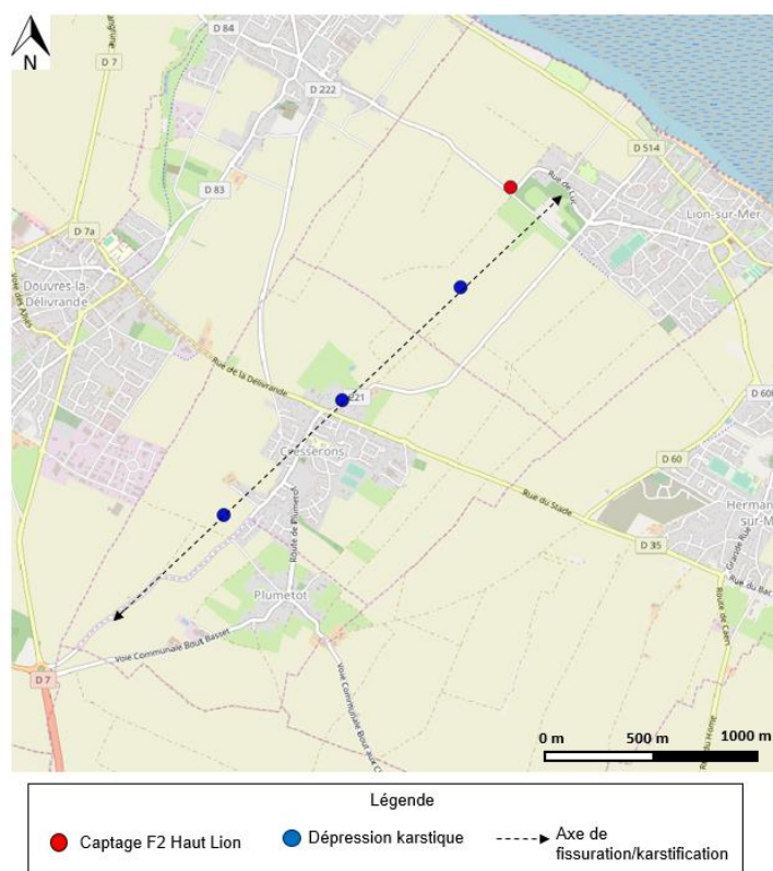
Figure 6 : Localisation des effondrements karstiques sur le secteur d'étude (source : modifié d'après rapport Lithologic R/OC/07.021a, avril 2007)
